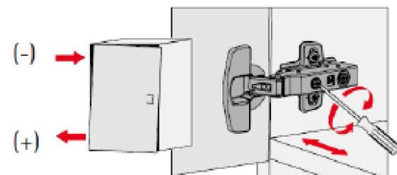
En tournant la vis à droite : le recouvrement de porte diminue (-).
