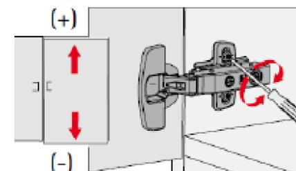
Des plaques de montage réglables en hauteur permettent d'ajuster les portes avec précision en hauteur.
